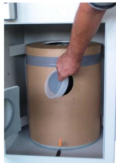
Verschliessen des Einwegbehälters
